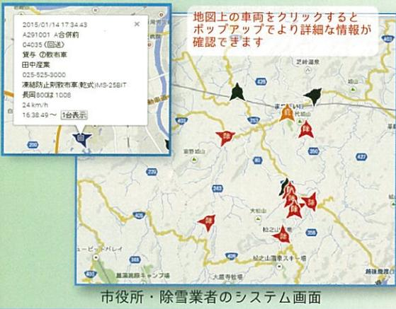
除雪車の現在地と当日の走行軌跡は、「回送」「通常除雪」「排雪」等の作業種別をシンボルで表示するほか、ライン又はシンボルの表示方法を切り替えることで除雪車の状態が分かるようになっています。
